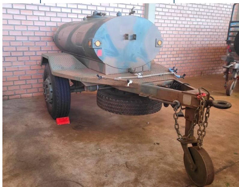
Imagem 4: Reboque cisterna 1 eixo padrão Exército 1500L
