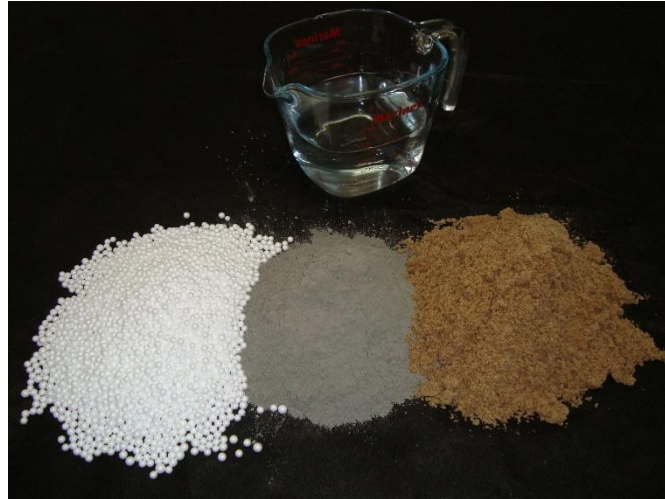
Figura 6 - Mistura para o concreto leve (Flocos de EPS, cimento, areia e água)
