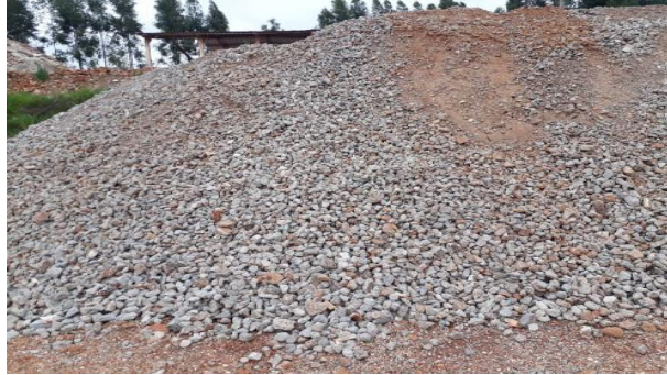
Figura 4 – Brita graduada cimentícia
