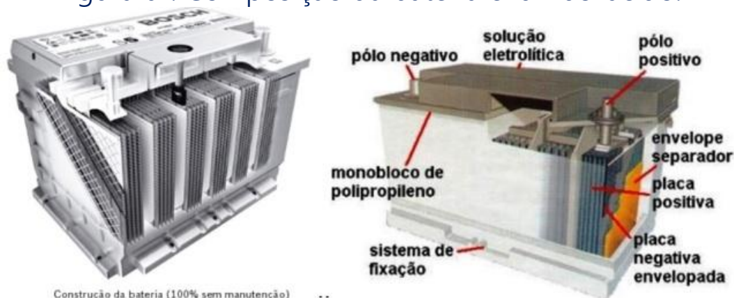
Figura 01: Composição da bateria chumbo-ácido:
