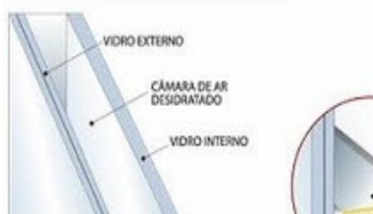
Figura 2 - Sistema de vidro duplo termo-acústico Fonte: penagrama.blogspot.com.br, 2011.
