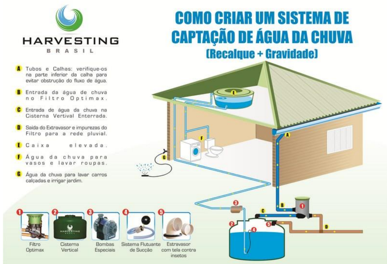
Imagem 2 – Sistema de captação de água da chuva: Recalque + Gravidade
