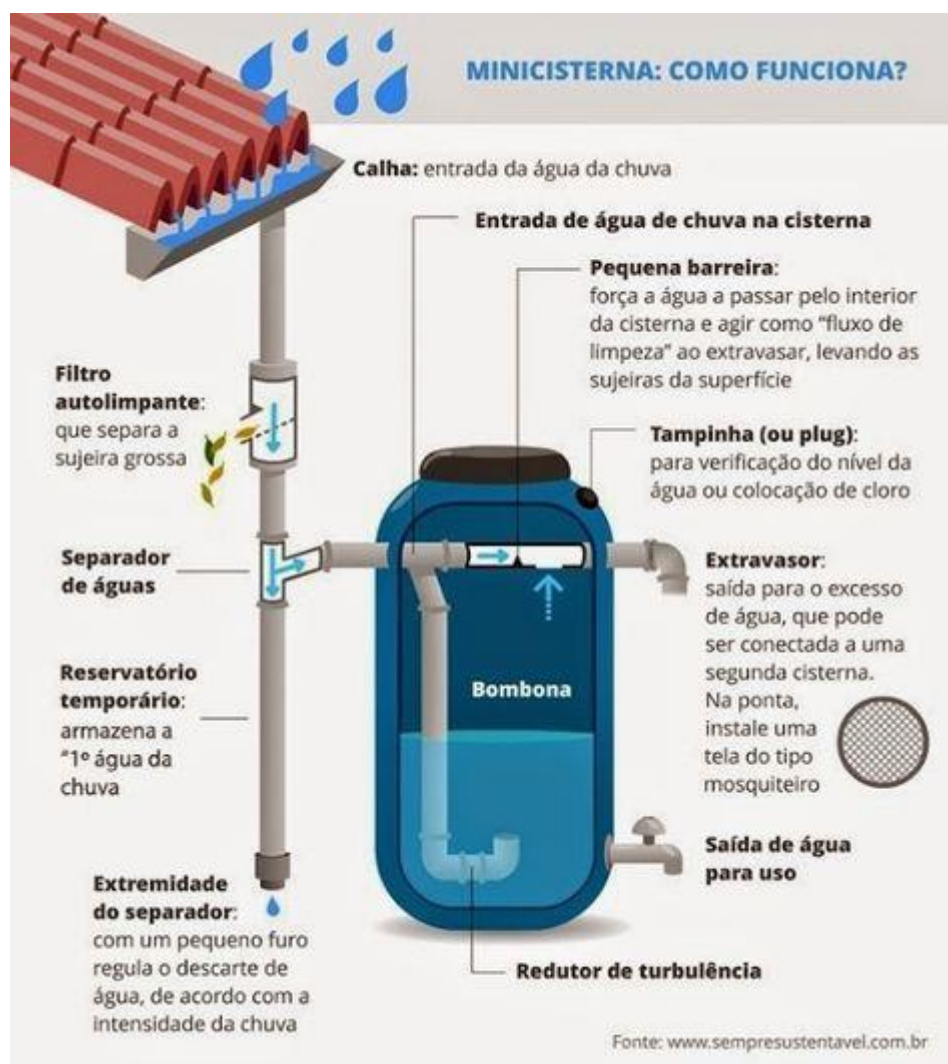
Imagem 1 – Reservatório para captação da água da chuva: como funciona
