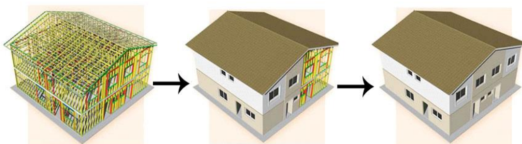
Figura 4. Etapas da construção Steel Frame.
