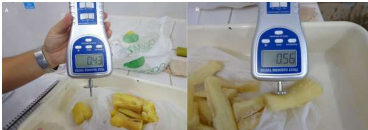
Figura 1 - Teste de resistência ou maciez realizado com penetrômetro digital de frutas modelo PTR 300 Instrutherm, com ponta de 6 mm.
