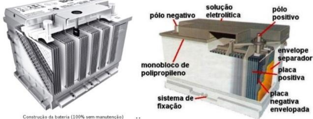
Figura 01: Composição da bateria chumbo-ácido:
